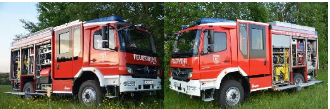
Löschgruppenfahrzeug LF 10, Aufbau Ziegler auf Fahrgestell Mercedes Benz 1529, Allrad
